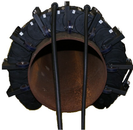
Рис. 1 б): Датчик ТТ на трубе диаметром 200 мм из углеродистой стали без изоляции.
