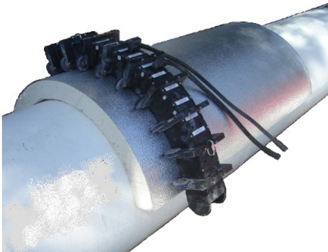
Рис. 1 г): Датчик ТТ на трубе диаметром 300 мм с тестовой изоляцией толщиной 50 мм.
